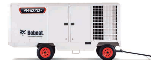
PA1070P Suministro de aire libre 30.3 m³/min Presión de trabajo nominal 24.10 bar Motor Caterpillar 3406 Cumplimiento de emisiones Nivel 1 Número de cilindros 6 Velocidad a carga completa 1800 RPM Potencia 347 kW Sistema eléctrico 24 V
