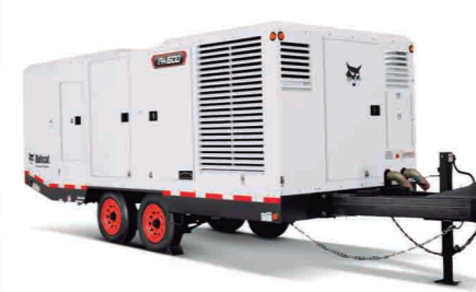
PA1600 Suministro de aire libre 45.3 m³/min Presión de trabajo nominal 10.30 bar Motor Cummins QSX15 Cumplimiento de emisiones Nivel 3 Número de cilindros 6 Velocidad a carga completa 1800 RPM Potencia 436 kW Sistema eléctrico 24 V
