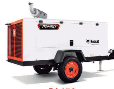
PA450 Suministro de aire libre 13.3 m³/min Presión de trabajo nominal 10.30 bar Motor Cummins 6BTA5.9C Cumplimiento de emisiones No emisión Número de cilindros 6 Velocidad a carga completa 1950 RPM Potencia 123 kW Sistema eléctrico 24 V
