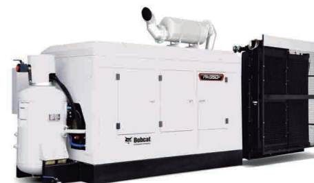
PA1350P Suministro de aire libre 38.23 m³/min Presión de trabajo nominal 25.2/27.6 bar Motor Cummins Cumplimiento de emisiones No emisión Número de cilindros 6 Velocidad máxima 1950 RPM Potencia 436 kW Capacidad de la batería 24 V 160 Ah
