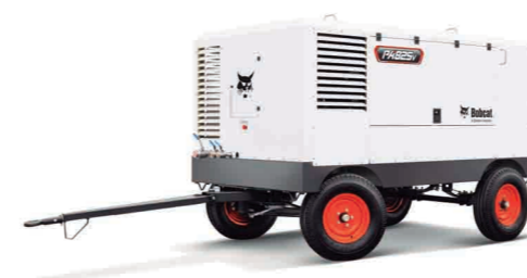
PA825V Suministro de aire libre 23.4 m³/min Presión de trabajo nominal 8.60 bar Motor Cummins QSB6.7 Cumplimiento de emisiones No emisión Número de cilindros 6 Velocidad a carga completa 2175/2000 RPM Potencia 201 kW Sistema eléctrico 24 V
